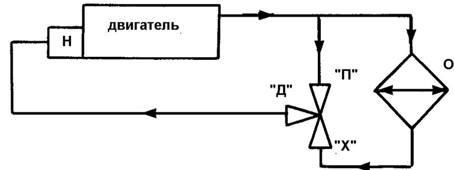
Маркировка патрубков: «Д» - двигатель
