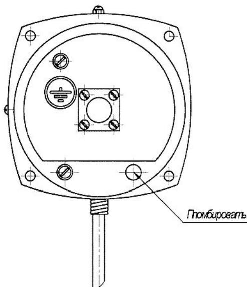
Рисунок 2 - Схема пломбирования
