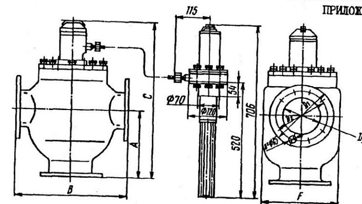
Габаритные размеры терморегуляторов
