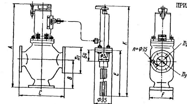
Габаритные размеры терморегуляторов
