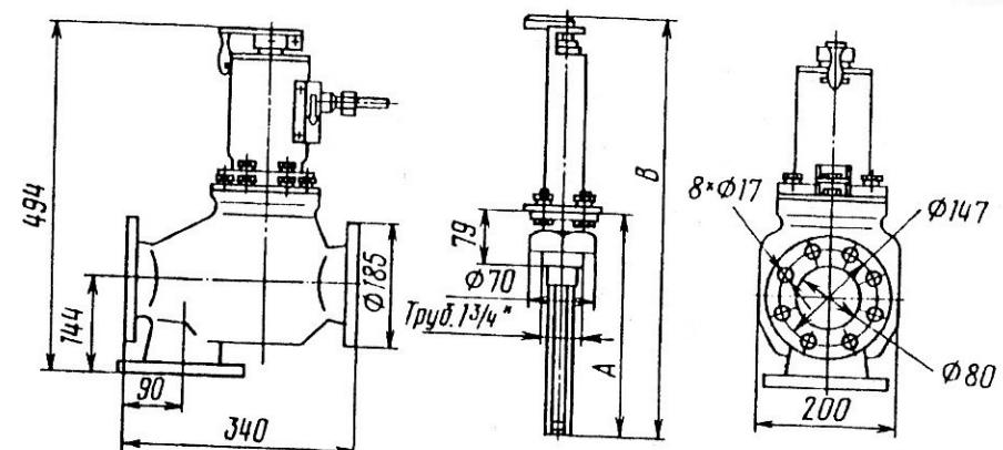
Габаритные размеры терморегулятора РТИД-80-Р
