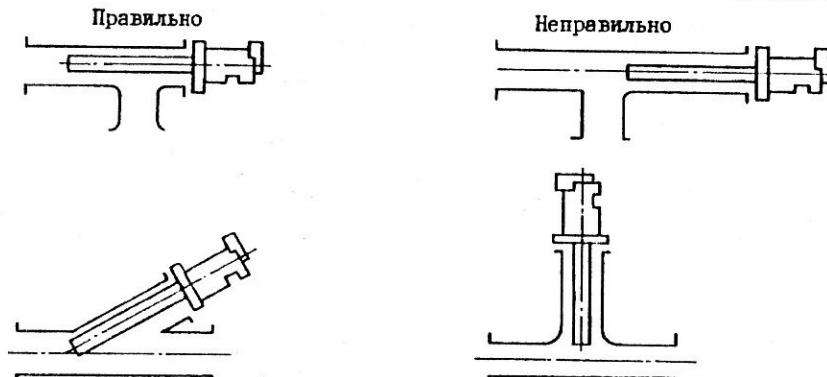
Схема установки термобаллона
